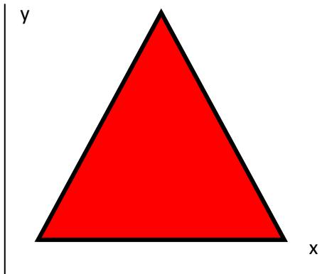
Das Beispiel zeigt ein **Objekt** aus der **Klasse DREIECK**. Innerhalb eines kartesischen Koordinatensystems ist die Lage der drei Eckpunkte mit je einem x- und einem y-Wert genau beschrieben. Dazu werden die **Attribute** für Linienart, Linienstärke, Linienfarbe und Füllfarbe gespeichert. Zur Veränderung von **Attributwerten** stehen **Methoden** wie `verschieben()`, `drehen()`, `skalieren()` oder `setzeFüllfarbe()` zur Verfügung.
