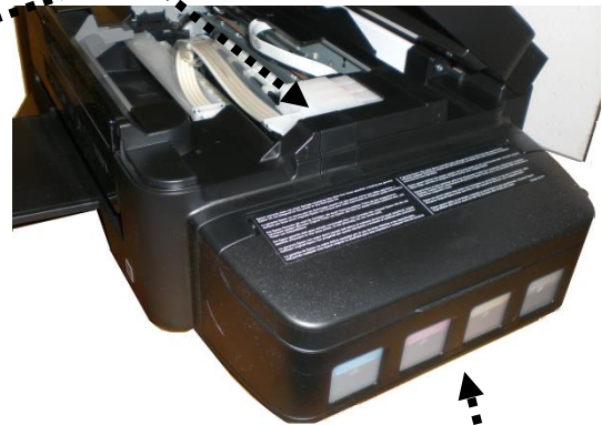
Tintenstrahl drucker mit vier großen Tintentanks („Ecotank“)
