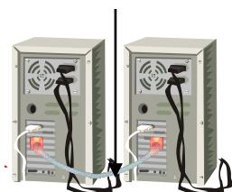
Dabei muss jedoch beachtet werden, dass jeweils ein Adernpaar für das Senden und ein anderes Adernpaar für das Empfangen reserviert ist. Bei einer direkten Verbindung würde der Eingang der einen Netzwerkkarte am Eingang der anderen und umgekehrt Ausgang an Ausgang anliegen.
