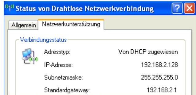
Das bedeutet für das Beispiel oben, dass alle PCs innerhalb des Netzes die Subnetzmaske 255.255.255.0 erhalten müssen. Dies ist eine Standardkonfiguration für kleinere Netze.
